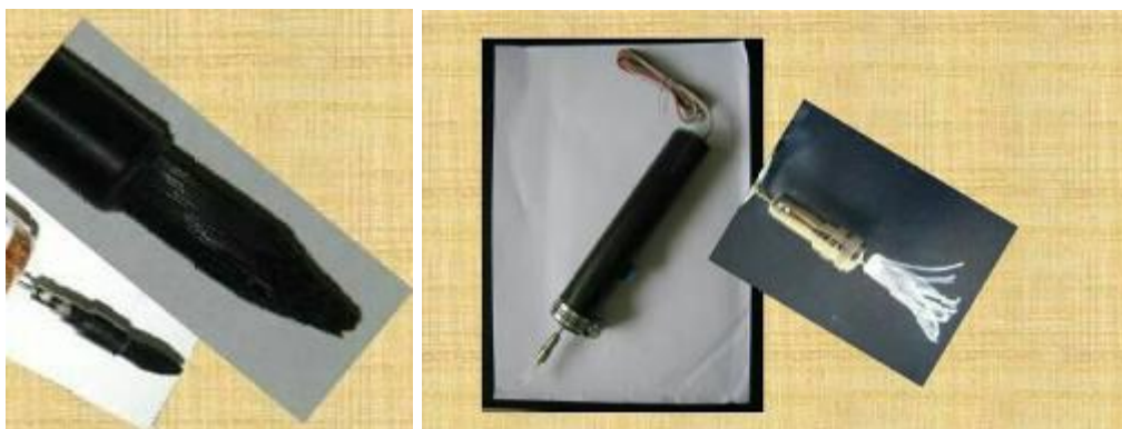
شکل ۴- نمونه‌ی دستگاه پرچم‌زدای برقی با برس نامناسب (سمت راست) و نمونه‌ی برس مناسب (سمت چپ) (اصلی).
